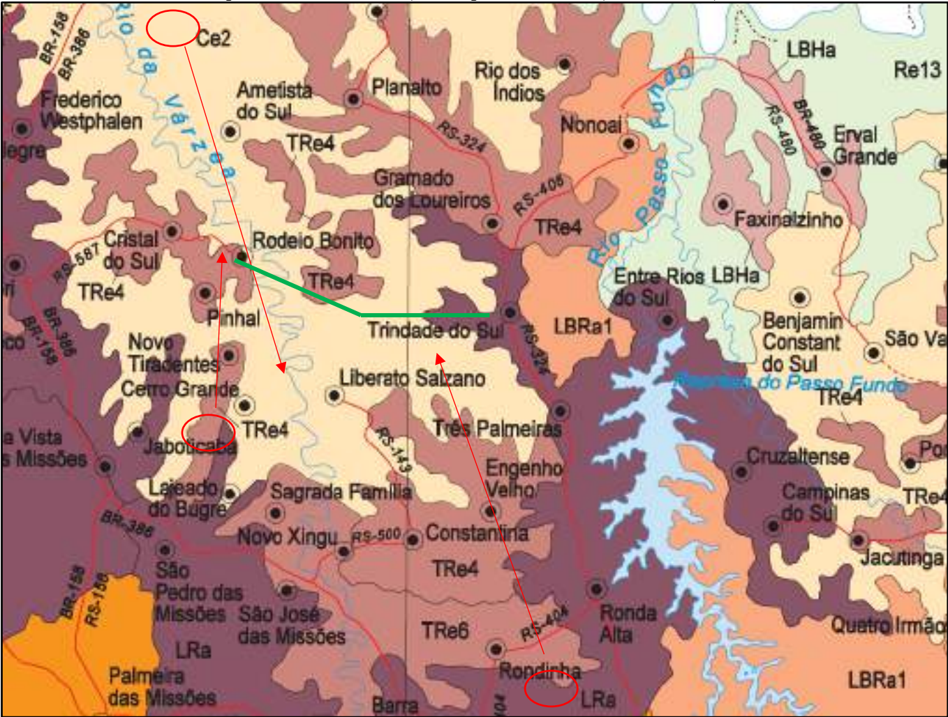
Figura 27. Porção do mapa exploratório de solos do Rio Grande do Sul, onde se cruza o trecho (trajeto aproximado em verde) a ser pavimentado. (Fonte IBGE).
